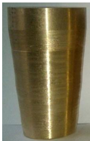
Рис. 2. Обточенный слиток из бериллиевой бронзы системы Cu–Be–Ni–Co–La
