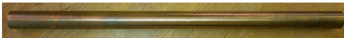
Рис. 3. Прессованный пруток из бериллиевой бронзы системы Cu–Be–Ni–Co–La
