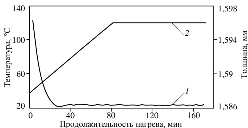
Рис. 6. Изменение толщины пакета (1) препрега марки СТ-69Н-14 в зависимости от приложенного давления сжатия при нагреве со скоростью 1^{\circ}\text{C}/\text{мин} (2 – температурный режим)
