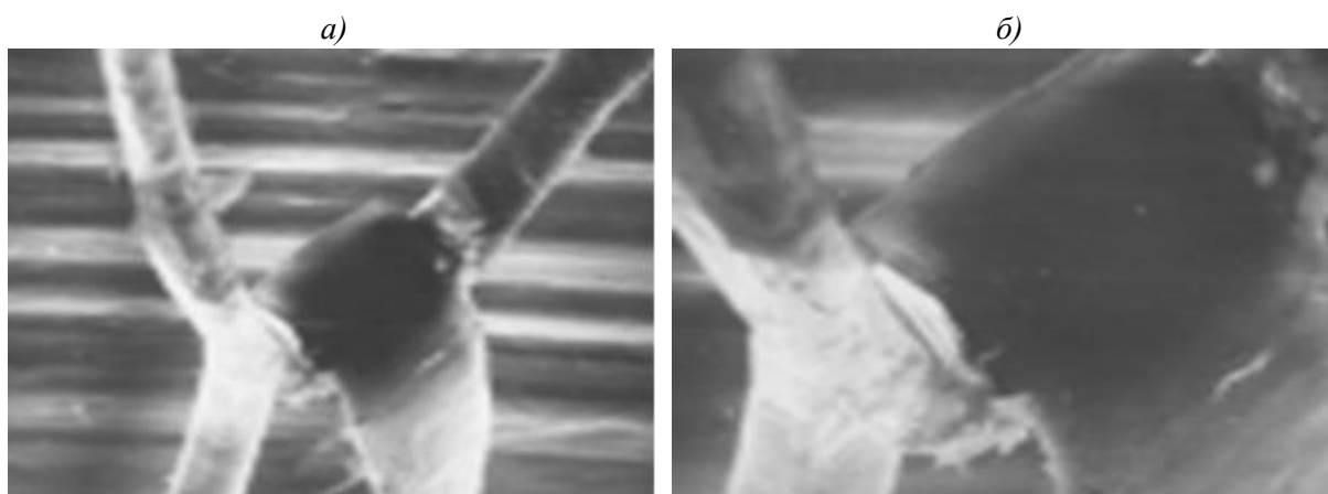
Рис. 4. Вид ( a – \times 2000 ; б – \times 5000 ) деформирования и разрушения волокна СВМ в петле (поперечное сечение)
