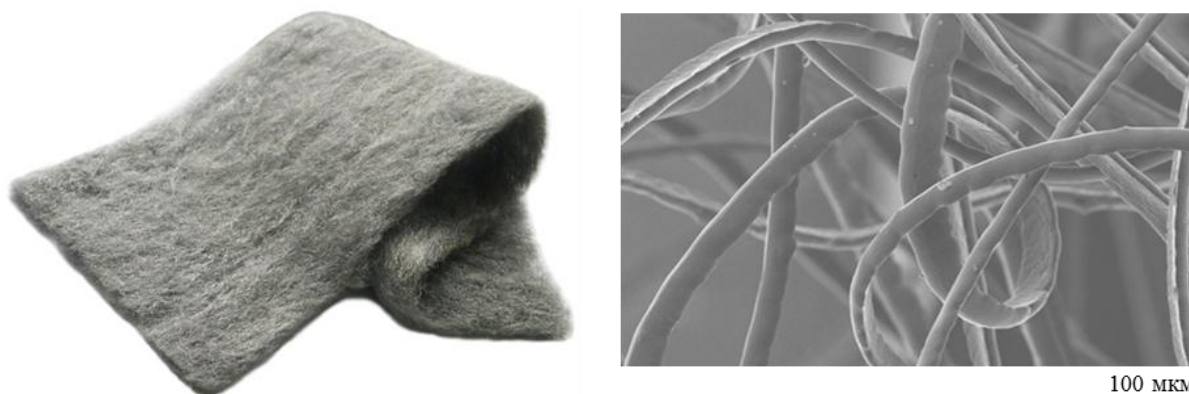
Рис. 5. Пористый материал из волокон сплава типа X23Ю5, полученный методом экстракции висящей капли расплава (а), и его структура (б)
