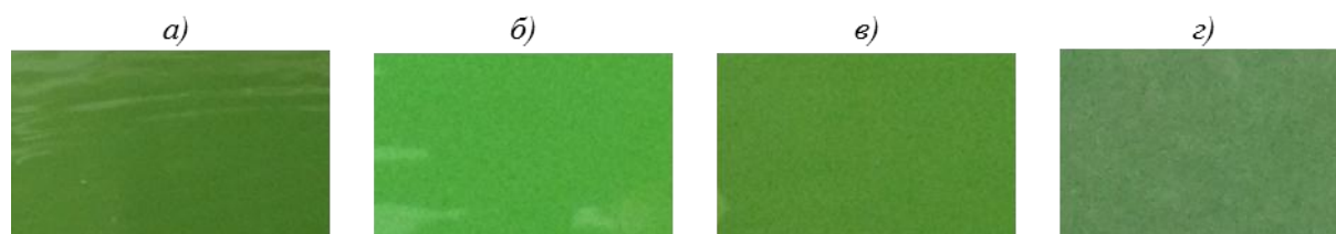
Рис. 9. Поверхность имитатора оснастки с антиадгезионной смазкой марки Safelease #30 из стеклопластика (а), полимерной плиты марки Niguron (б), алюминиевого сплава Д16ч.-АТ (е) и МДФ (з)
