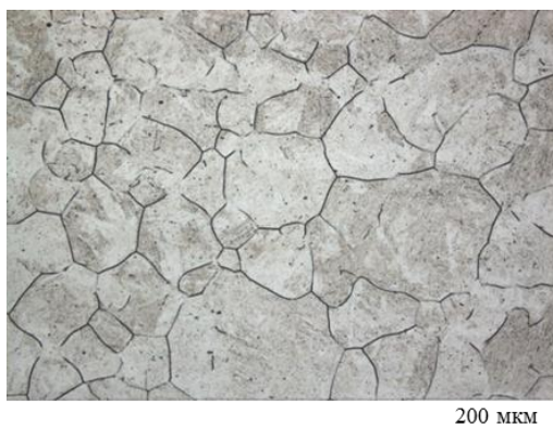
Рис. 1. Микроструктура стали 17X13H4K6CAM3ч после стандартной термообработки (поперечный шлиф, травление на зерно)
