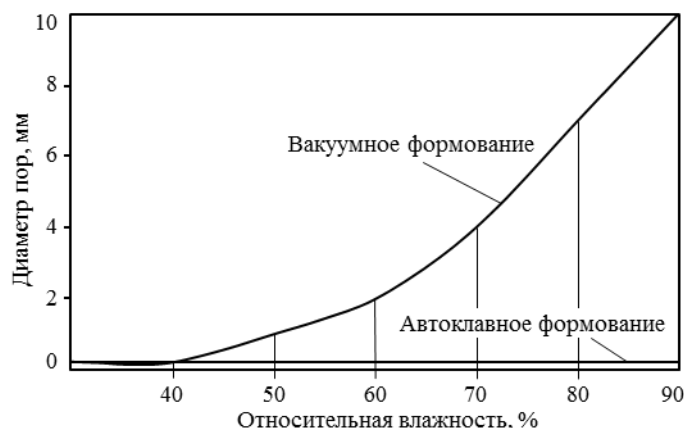
Рис. 1. Диаметр пор для вакуумного и автоклавного формования в зависимости от относительной влажности (расчетные значения) [24]
