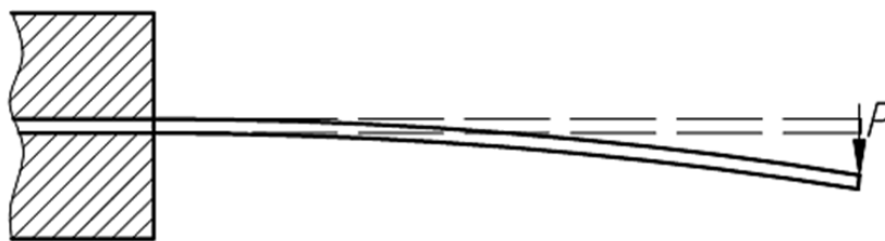
Рис. 3. Схема изгиба консольной балки под нагрузкой
