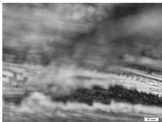
Рис. 4. След от индентора на углепластике
