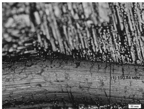
Рис. 5. Бороздка на покрытии, полученном натиранием
