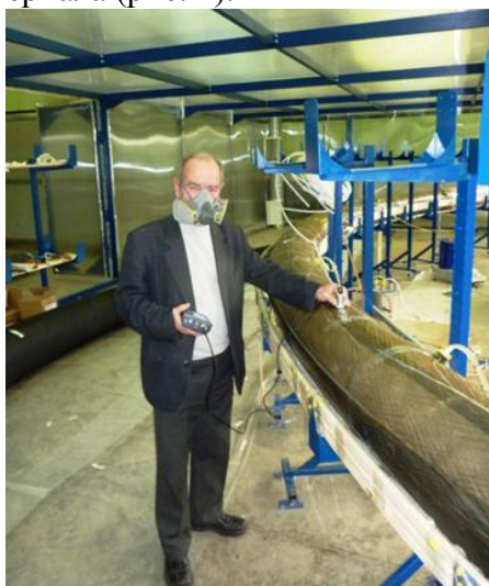
Рис. 1. Рабочий момент контроля качества изготовления оболочки арочного элемента с пустотелой полостью после ее формования
