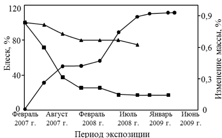
Рис. 4. Изменение массы (●) и блеска на лицевой (■) и обратной (▲) стороне в процессе натуральных испытаний стеклопластика СТ-69Н-15П
