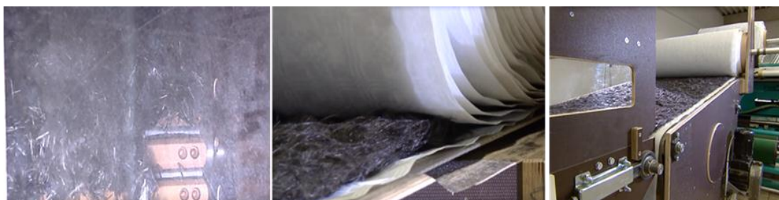
Рис. 7. Процесс разрыхления и формирования равномерного холста [10]
