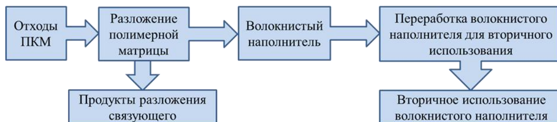
Рис. 1. Общая схема утилизации ПКМ с волокнистым наполнителем и вторичное использование компонентов ПКМ
