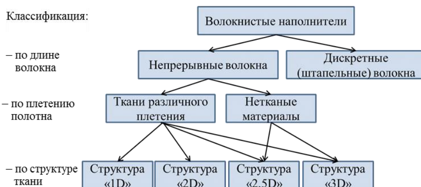
Рис. 2. Классификация волокнистых наполнителей, применяемых для создания ПКМ
