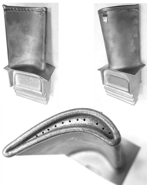
Рис. 6. Внешний вид рабочей лопатки первой ступени ТВД из сплава ЖС32-ВИ с наплавленными слоями порошка ЖС32-ВИ
