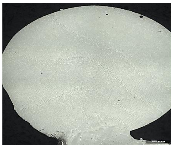
Рис. 9. Вид наплавленного слоя на рабочей лопатке (поперечный микрошлиф)
