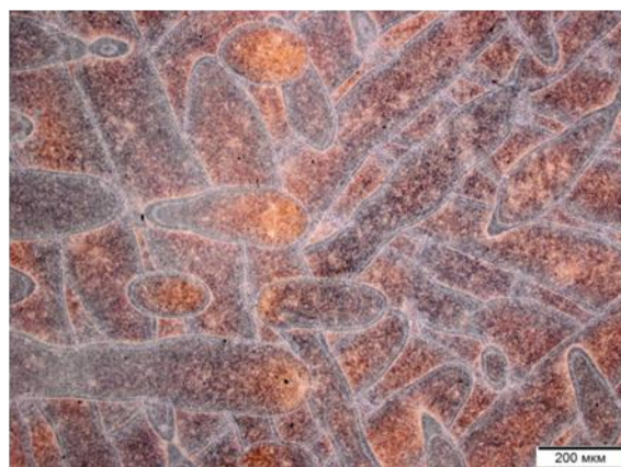
Рис. 3. Микроструктура образцов из сплава АК9с. в синтезированном состоянии и после отжига
