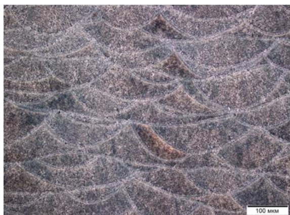
Рис. 3. Микроструктура образцов из сплава АК9с. в синтезированном состоянии и после отжига
