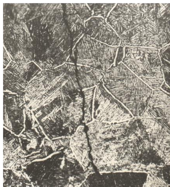
Рис. 3. Фрагменты коррозионных трещин в сплаве ВТЗ-1 (в отожженном состоянии) с микроструктурой 1–3 типов (а – \times 600 ) и 7–8 типов (б – \times 340 )
