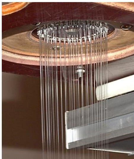
Рис. 1. Многокапиллярная фильера для формования непрерывного волокна
