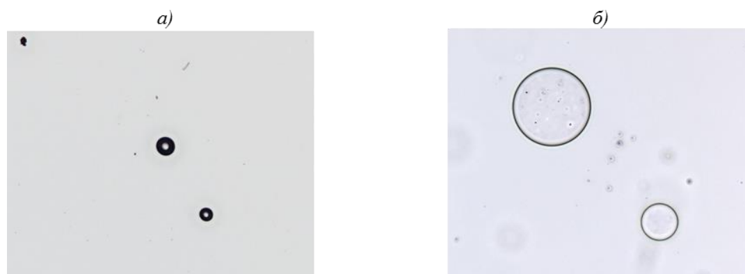
Рис. 2. Включения в формовочном растворе: а – газовые пузырьки; б – включения второй жидкой фазы
