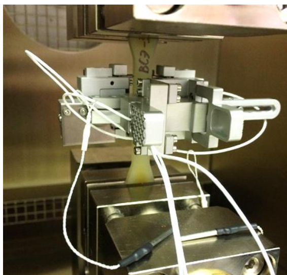
Рис. 3. Образец связующего ВСЭ-34 с установленным экстензометром продольной и поперечной деформации
