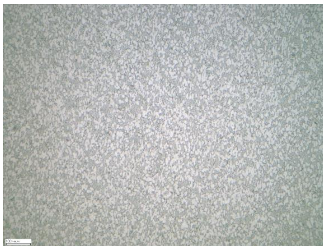
Рис. 1. Типичная микроструктура ( \times 100 ) изотермической штамповки, изготовленной с применением (\alpha+\beta) -деформации на конечной операции изготовления
