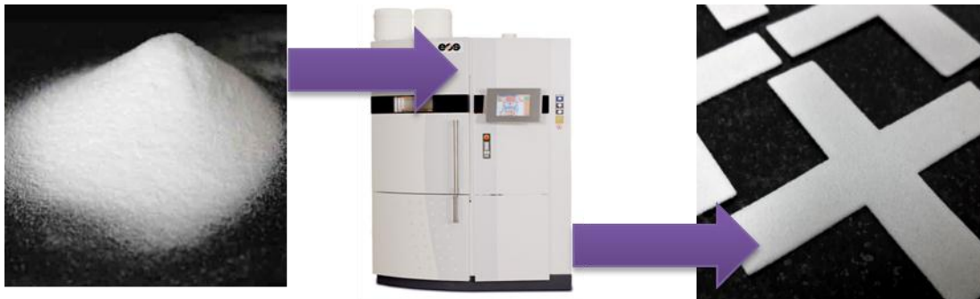
Рис. 12. Схема переработки методом SLS термопластичной порошковой композиции на установке Formiga P110
