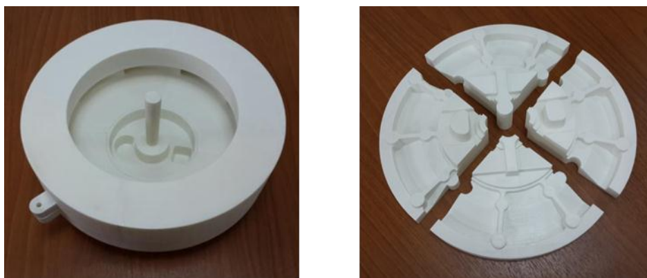
Рис. 1. Заготовки (модели) сложной геометрической формы для алюминиевого и магниевого литья, которые изготовлены с использованием FDM технологии 3D-печати во ФГУП «ВИАМ»
