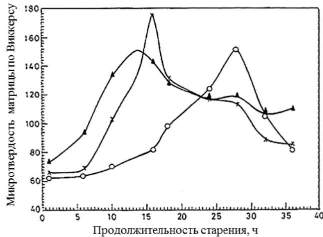
Рис. 13. Измерение микротвердости матричного сплава марки 7010 (○) и композиционных материалов 7010–10%SiC (×) и 7010–20%SiC (▲) от продолжительности старения
