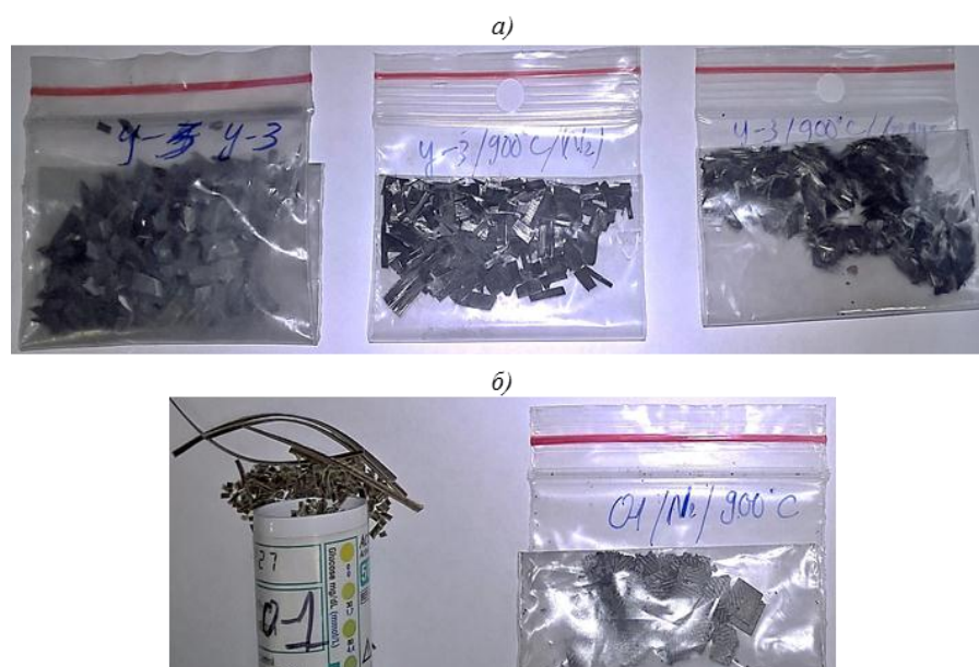
Рис. 1. Внешний вид образцов из углепластика У-3 (а) и органопластика О-1 (б) в исходном состоянии и термообработанных
