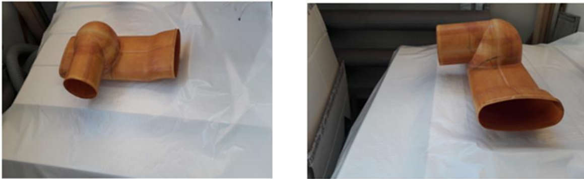
Рис. 5. Экспериментальный образец элемента системы кондиционирования воздуха (тройник)
