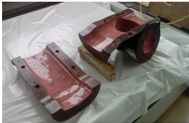
Рис. 4. Частично собранная формообразующая полимерная оснастка
