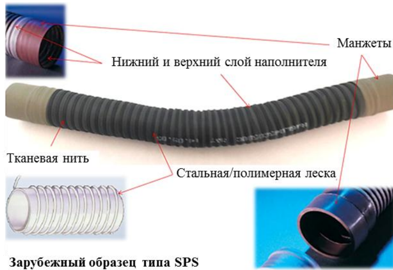
Рис. 6. Типовая конструкция гибкого элемента системы кондиционирования воздуха
