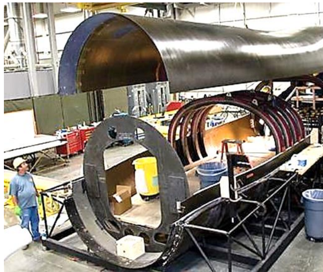
Рис. 1. Изготовление с использованием семипрега марки МТМ-45-1 элемента фюзеляжа грузового транспортного самолета (компания Advanced Composite, США)
