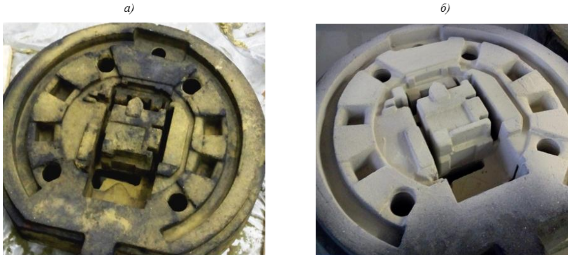
Форма из холодно-твердеющей смеси без покрытия (а) и с противопригарным покрытием (б)
