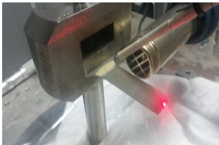
Рис. 3. Внешний вид вибростенда ETS Solution MPA 403–M124M с закрепленным образцом в оснастке
