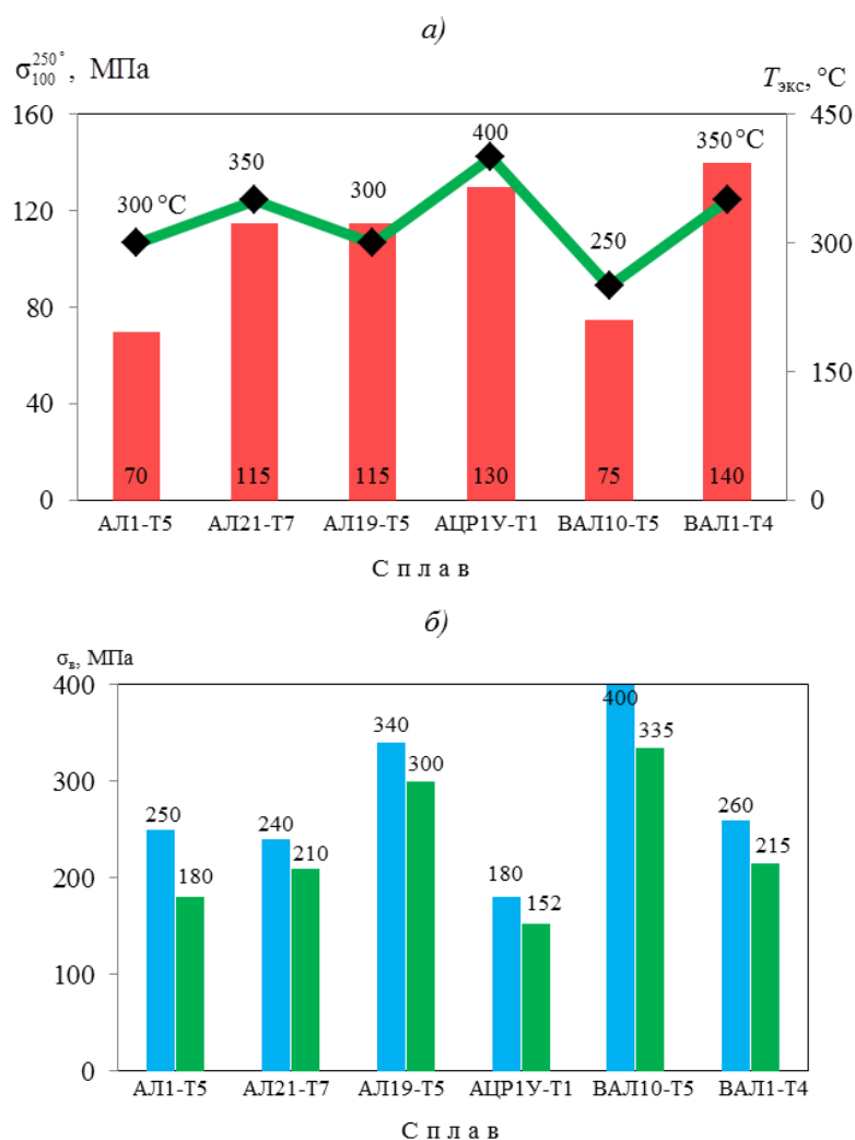
Рис. 1. Механические свойства высокопрочных и жаропрочных сплавов при комнатной и высоких температурах: а – жаропрочность при 250°C на базе 100 ч (■) и температура эксплуатации (—◆—); б – предел прочности при 20 (■) и 200°C (■)
