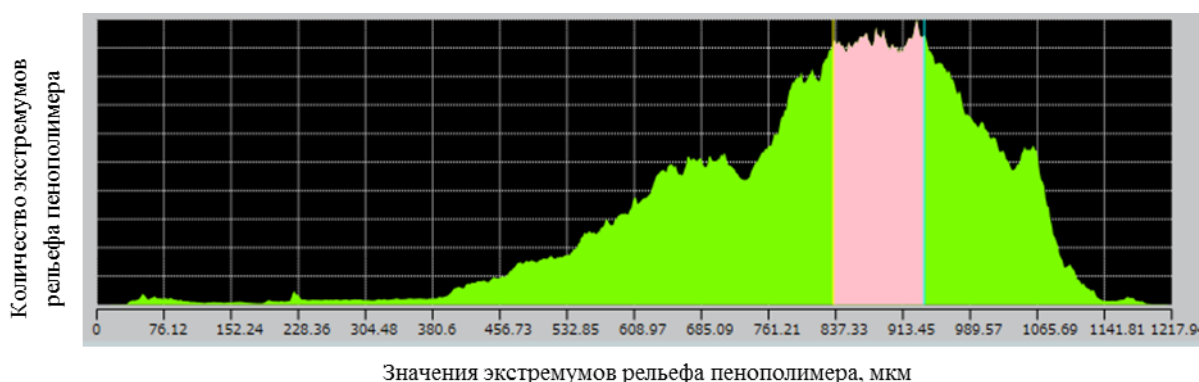
Рис. 7. График плотности распределения значений экстремумов рельефа поверхности образца пенополимера в плоскости xу , снятого в лазерном режиме с помощью сшивки изображений
