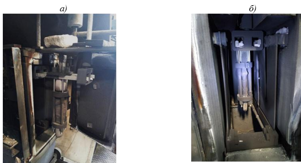
Рис. 7. Общий вид керамической формы в специальной оснастке установки УВНК-9 до ( а ) и после заливки ( б )
