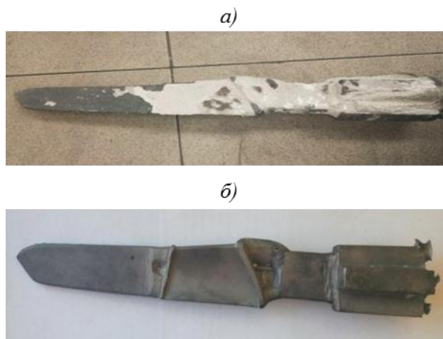
Рис. 8. Общий вид залитой отливки сопловой лопатки после удаления остатков керамики (а) и после пескоструйной обработки (б)
