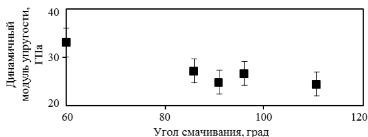
Рис. 6. Зависимость динамического модуля упругости от угла смачивания пленки модификатора эпоксидным олигомером ЭД-20
