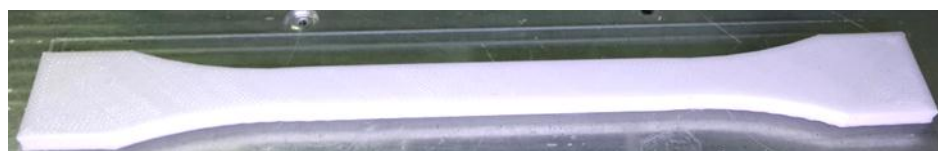
Рис. 3. Лопатка для испытаний при растяжении, изготовленная по технологии послойного синтеза
