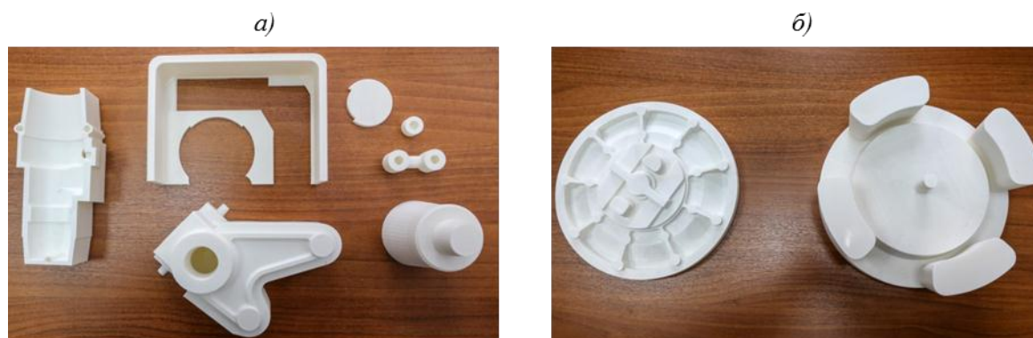
Рис. 7. Элементы модели (а) и модель (б) отливок для алюминиевого и магниевого литья
