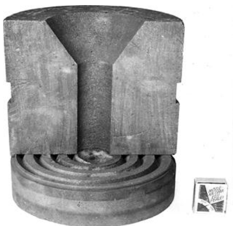
Рис. 1. Графитовая форма для определения жидкотекучести в разобранном виде
