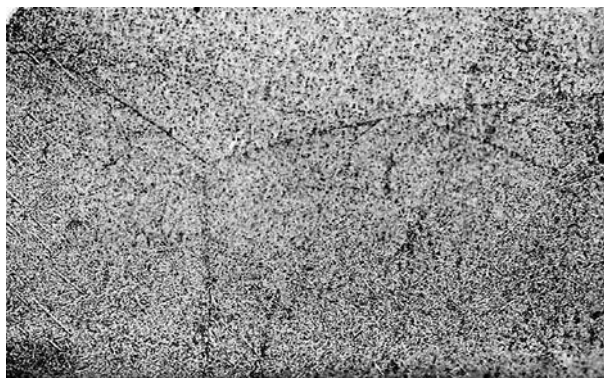
Рис. 8. Микроструктура ( \times 500 ) литой заготовки сечением 10 мм после ГИП
