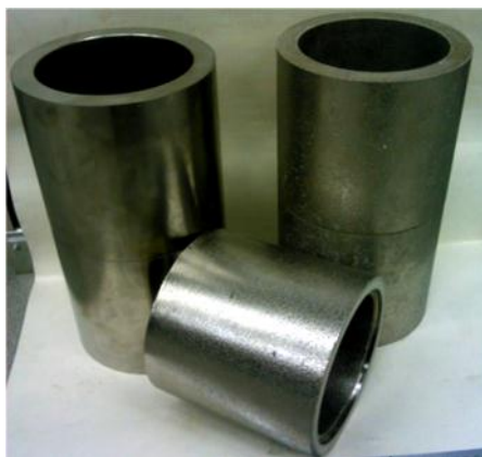
Рис. 4. Внешний вид литых составных трубных катодов, полученных с применением обработки расплава электромагнитным полем в процессе кристаллизации
