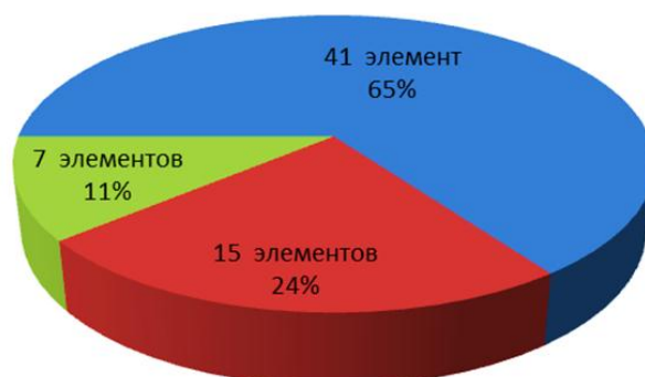
Рис. 1. Распределение двойных систем магния с учетом взаимодействия легирующих элементов с магнием в жидком состоянии, полученное расчетным путем с использованием критерия Гильдебранда–Скотта, а также числа Мотта
