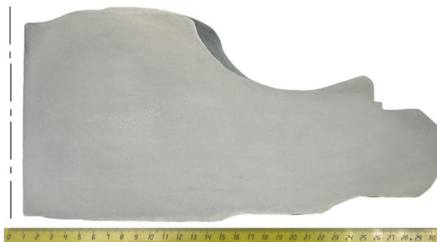
Рис. 4. Макроструктура штамповки из сплава ЭК151-ИД
