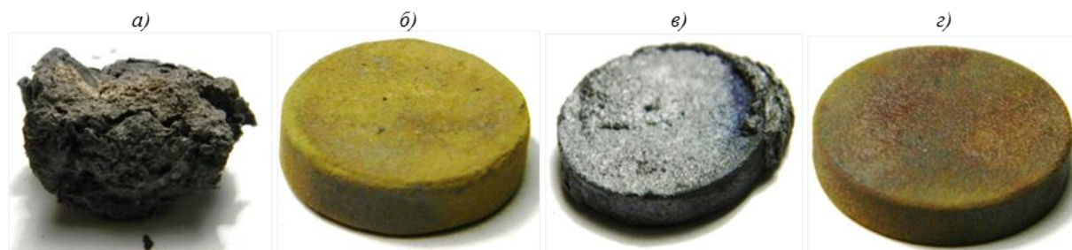
Рис. 3. Внешний вид образцов из естественно-композиционного материала на основе ниобия после испытания на изотермическую жаростойкость при температуре 1350°C на базе 30 ч образцов без покрытия (а), с покрытием на основе Si (б) и с комплексными жаростойкими покрытиями систем Si+(Fe–Cr–Al–Y) (в) и Si+(Fe–Cr–Al–Y)+Si (г)
