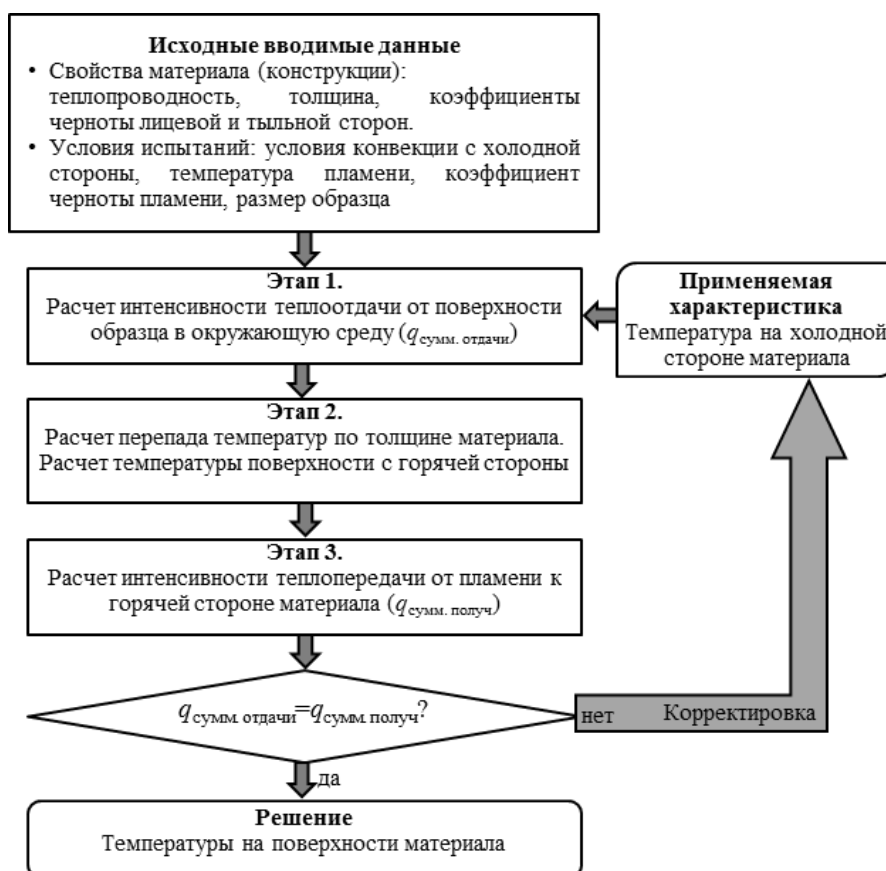
Рис. 1. Алгоритм расчета температурных характеристик поверхностей материала при воздействии пламени (стационарный процесс)
