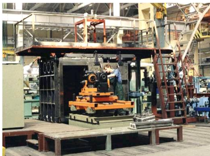
Рис. 3. Внешний вид установки ЭЛСМ-03 «АЭЛТК-75/7.5-4.5»
