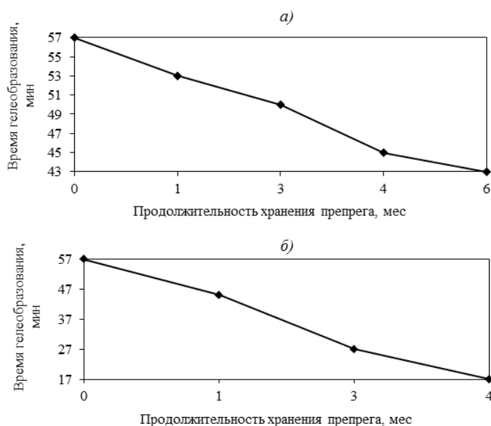
Рис. 2. Зависимости времени гелеобразования связующего в препреге от продолжительности хранения исследуемого препрега в условиях холодильной камеры (а) и цеха (б)
