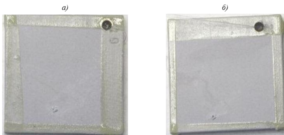
Рис. 7. Образцы из магниевого сплава с ПЭО покрытиями, сформированными по режимам 1 (а) и 2 (б), после экспозиции в течение 96 ч в камере солевого тумана
