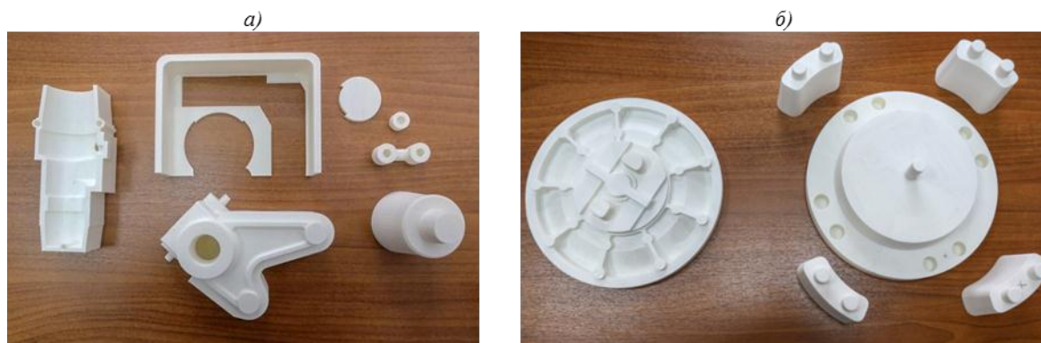
Рис. 4. Элементы модели (а) и модель (б) отливок для алюминиевого и магниевого литья
