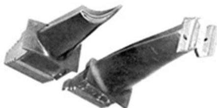
Рис. 1. Лопатки турбины с использованием паяных соединений
