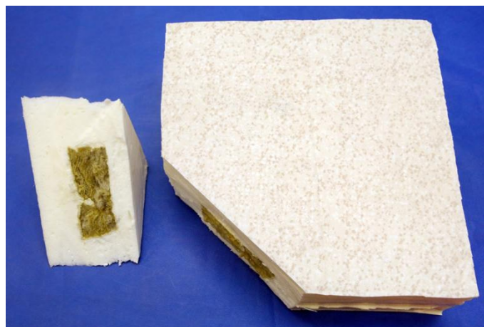
Рис. 4. Внешний вид звукопоглощающей панели марки ВТИ-26
