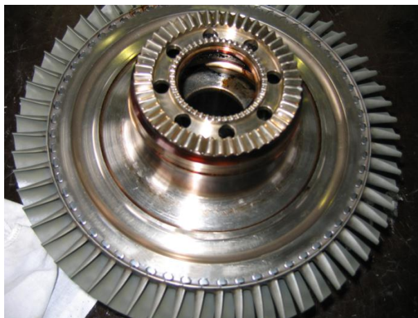
Рис. 2. Опытный образец-демонстратор конструкции типа «блиск»
