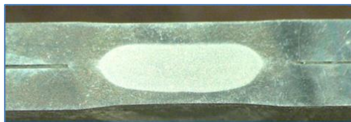
Рис. 6. Вид сварного соединения ( \times 8 ) алюминий-литиевого сплава 1441-T1 (листы толщиной 1,0 мм)
