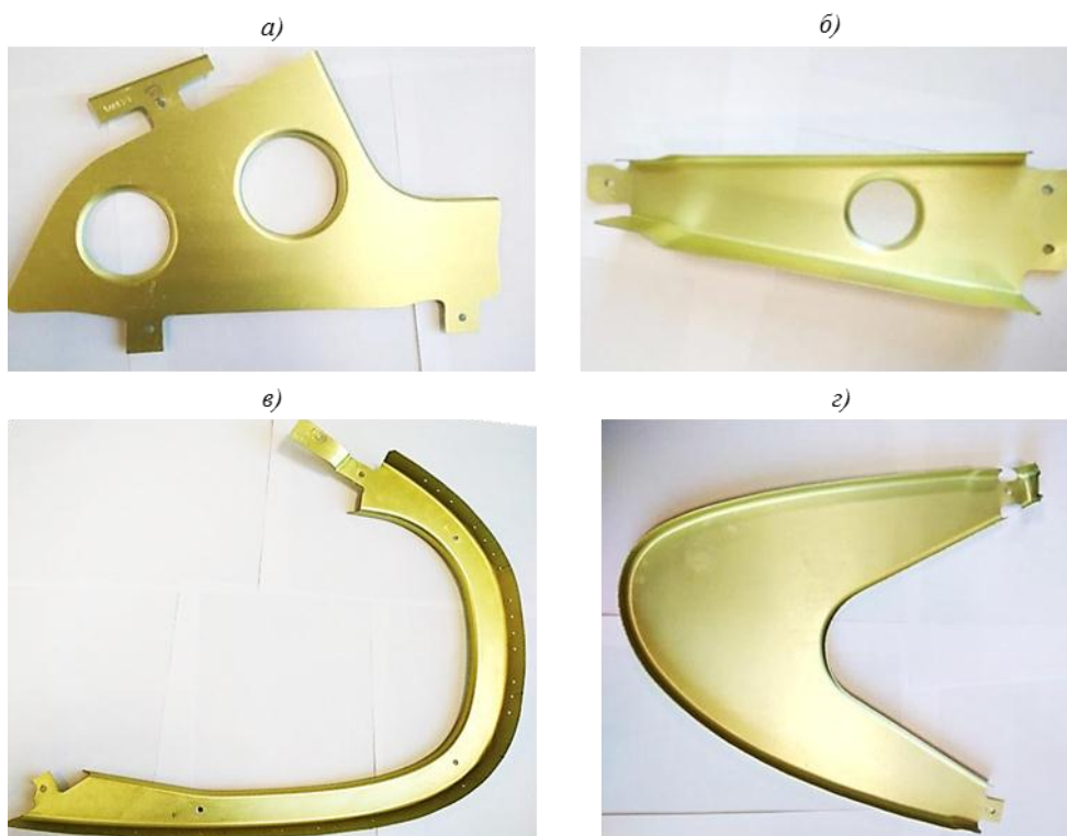
Рис. 1. Детали из листов алюминий-литиевого сплава 1441 толщиной 1,0 мм
