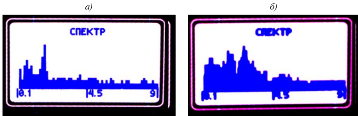
Рис. 5. Спектр принятого сигнала при контроле нагревательной наклейки в бездефектной зоне при f_0=1,65 кГц (а) и в дефектной зоне при f_0=2,72 кГц (б)
