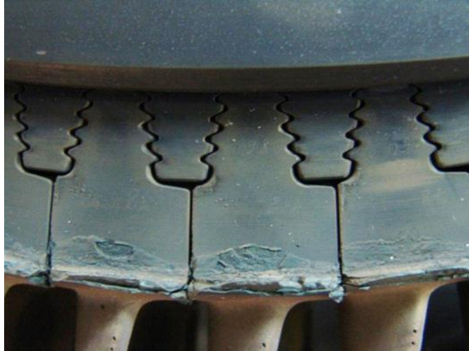
Рис. 1. Коррозионные повреждения на лопатках турбины ГТД
