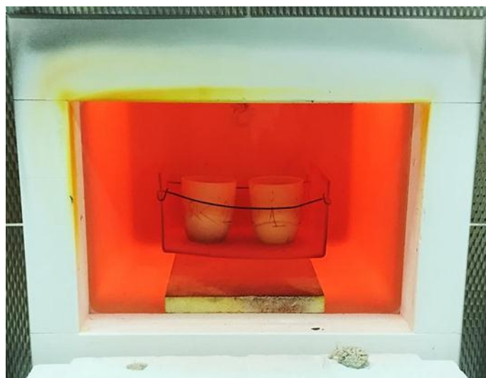
Рис. 4. Процесс испытаний образцов на стойкость к высокотемпературной коррозии в печи с воздушной атмосферой
