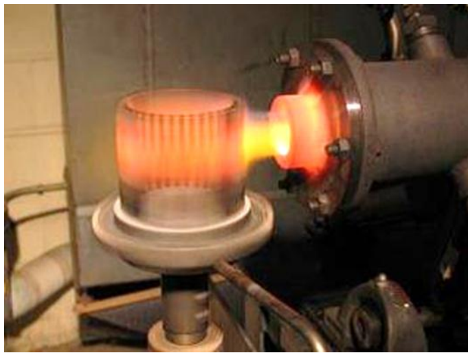
Рис. 2. Вид установки для проведения стендовых испытаний на стойкость к высокотемпературной коррозии [31]
