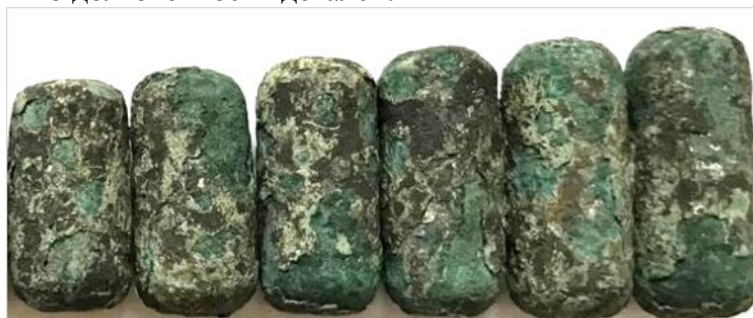
Рис. 5. Вид образцов жаропрочного сплава после проведения испытаний в печи
