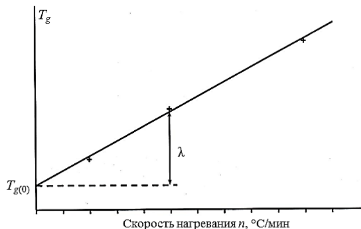
Рис. 5. Определение температуры стеклования T_{g(0)} и отклонения \lambda по калибровочному графику
