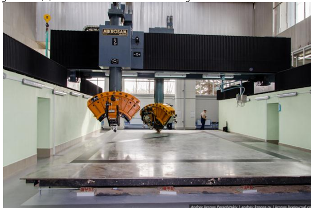
Рис. 2. Автоматизированная установка для выкладки методом ATL в АО «ОНПП «Технология»
