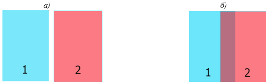
Рис. 1. Схематические изображения зазора (а) и нахлеста (б) между двумя (1 и 2) лентами
