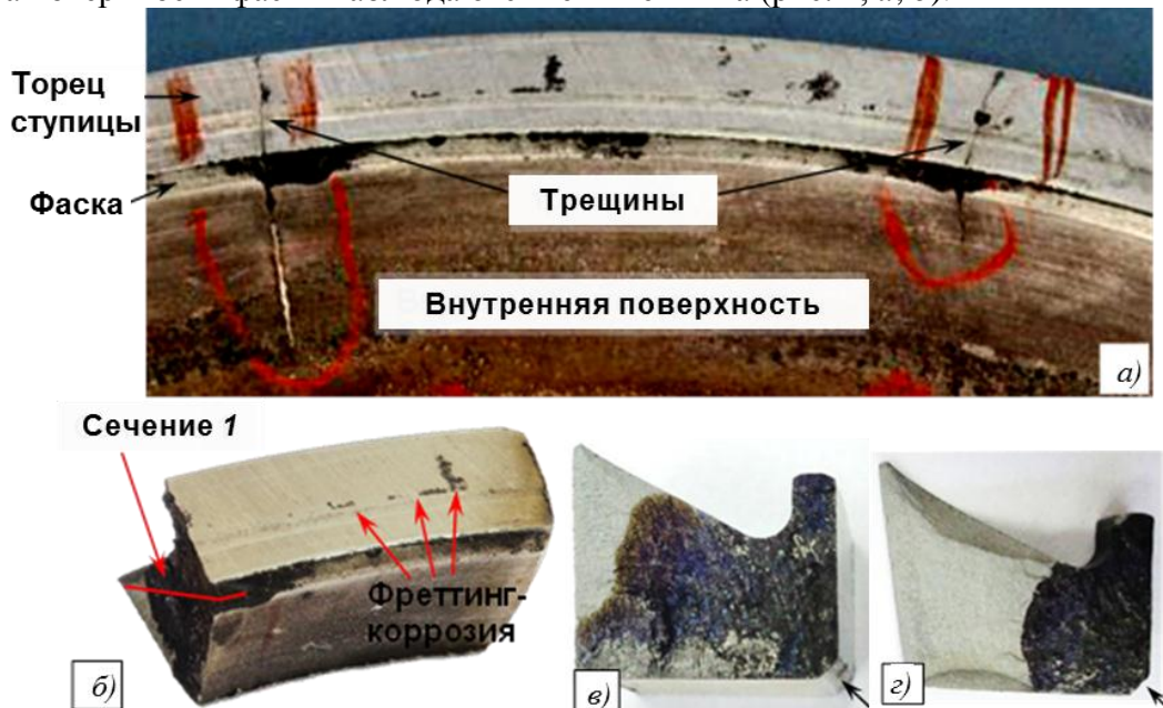
Рис. 1. Общий вид повреждений диска:
