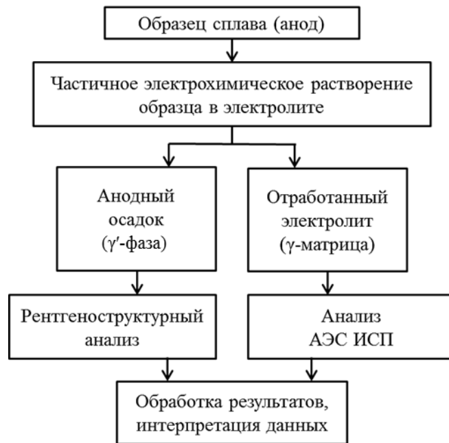
Рис. 2. Схема исследования количественного фазового состава жаропрочного никелевого сплава с применением электролитической экстракции и атомно-эмиссионной спектроскопии с индуктивно связанной плазмой (АЭС ИСП) для анализа электролитов
