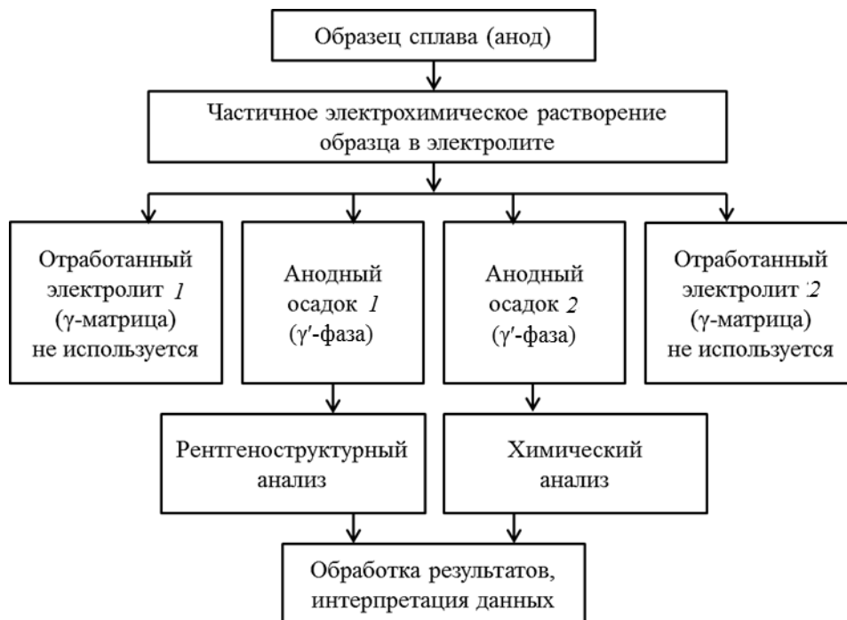
Рис. 1. Схема исследования количественного фазового состава жаропрочного никелевого сплава с применением электролитической экстракции фаз
